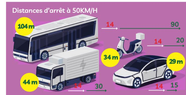
→ Temps de réaction      → Temps de freinage
